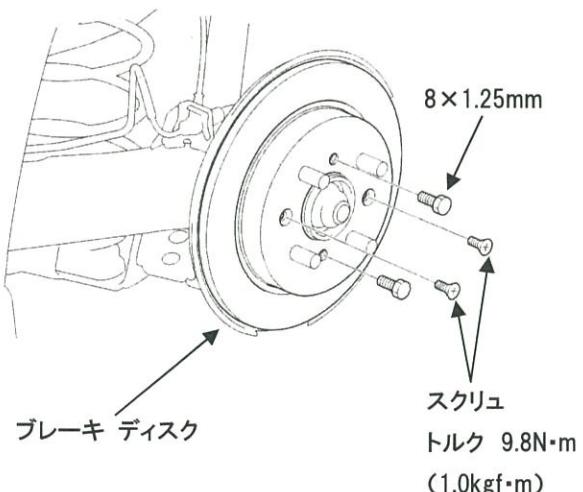
⑨取付けは取外しと逆の手順で行い、ブレーキペダルを踏んでブレーキが作動する事を確認する。
