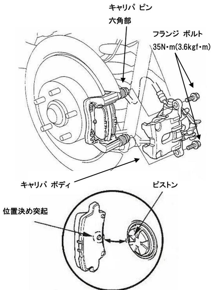
④キャリパ ボディを元の位置に戻し、キャリパ ピン六角部をレンチで保持してフランジ ボルトを規定トルクで締付ける。
