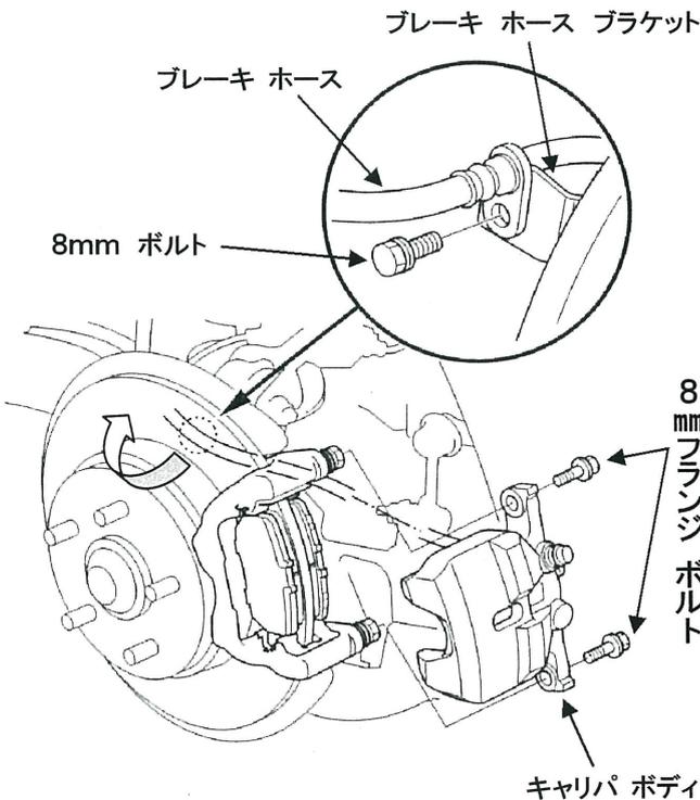
④8mmフランジボルトを取外し、キャリパボディをブラケットから取外す。
