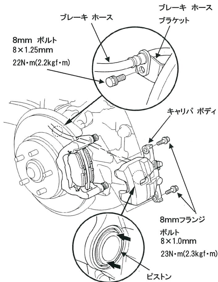
④キャリパ ボディを元の位置に戻し、8 mm フランジ ボルトを規定トルクで締め付ける。
