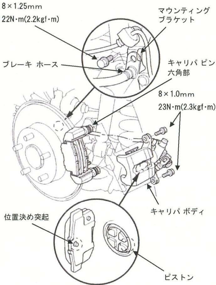
④キャリパ ボディを元の位置に戻し、キャリパ ピン六角部をレンチで保持して8 mmフランジ ボルトを規定トルクで締付ける。
