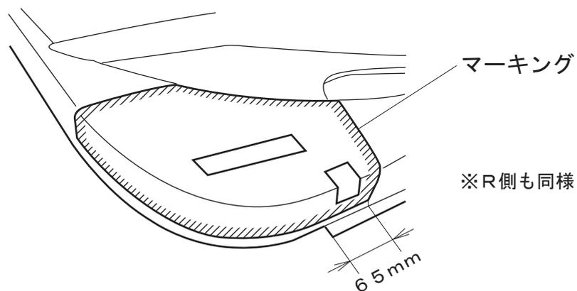
⑦ ドア サイン ライト ガーニッシュの両面テープの離型紙を短い2枚は全部剥がし、残りは30mmほど剥がし表に折り曲げマスキングテープで固定する。
