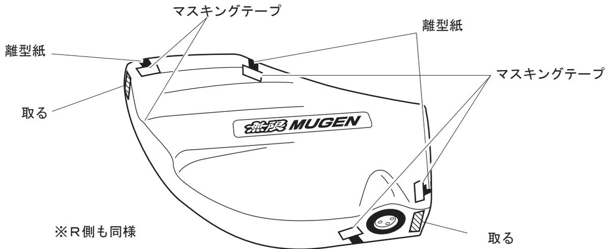
⑧ ドア サイン ライト ガーニッシュをマーキングに合わせてドア ライニングに取り付け、離型紙を矢印の方向に剥がし、圧着する。
