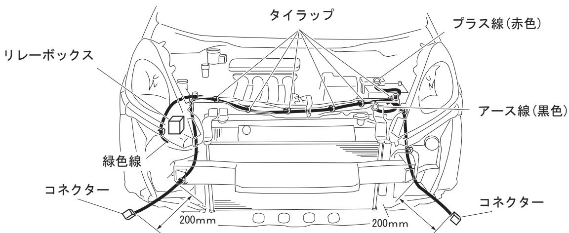
⑥運転席側のリレーボックスを分解し、下図リレーボックスの■印の車両ハーネス(茶)にエレクトロタップでイルミハーネスの緑線を接続する。
