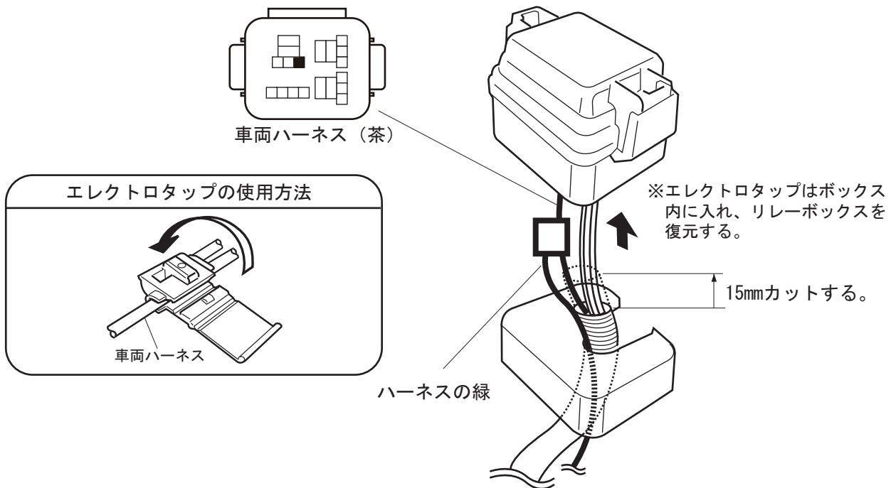
⑦ハーネスのプラス線(赤色)をバッテリーのプラス端子へ、アース線(黒色)を車両アースポイントにそれぞれ接続し、ハーネスの下図位置をタイラップで固定する。
