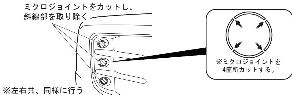
⑩フロントアンダースポイラーにブラケットを取り付け後、LEDを6箇所取り付ける。
