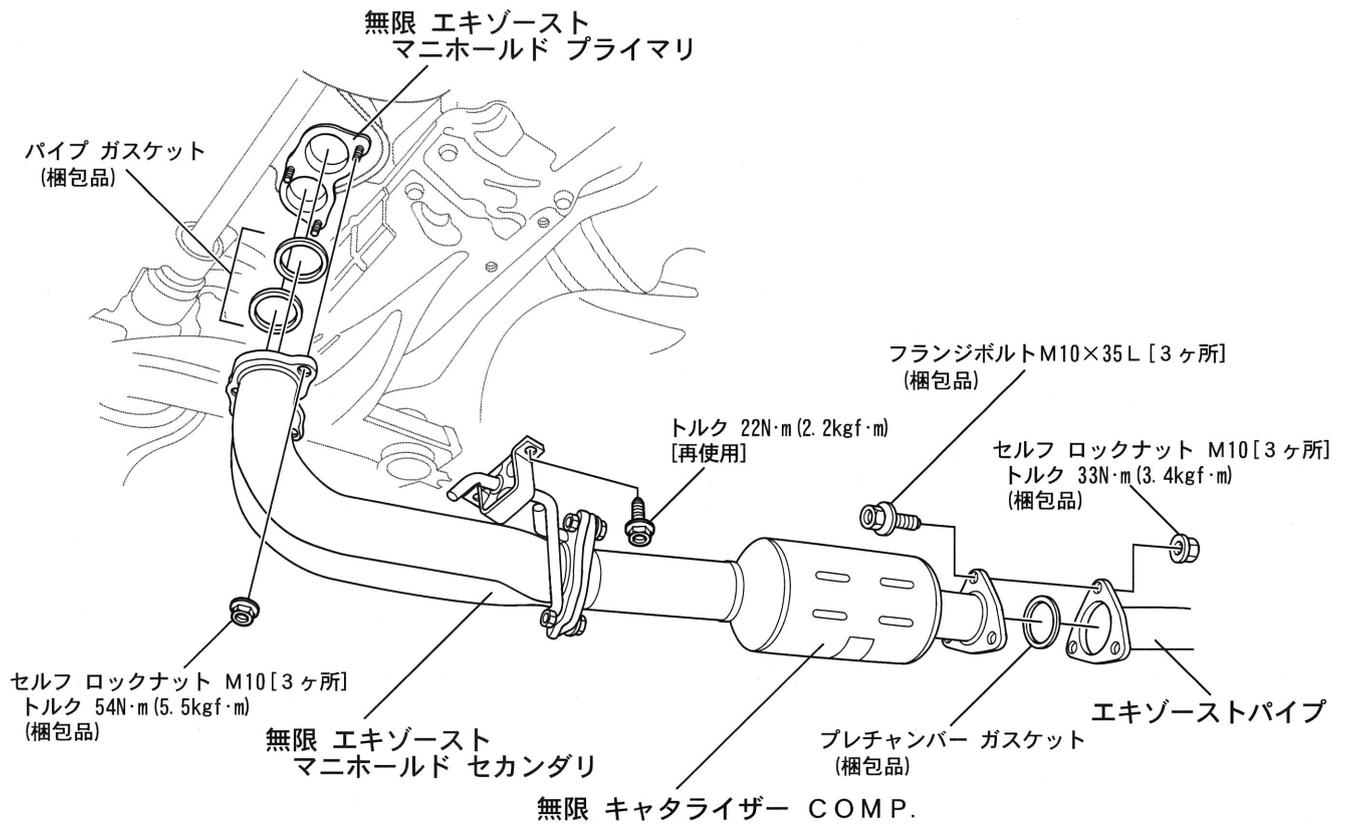
※ エキゾースト マニホールドの取付ボルト/ナットを締付ける際は、内側から外側へ対角に数回に分けて締付ける。
