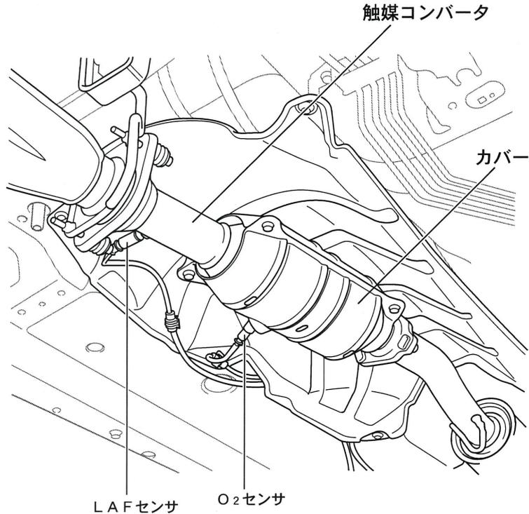
※ 各センサは、触媒コンバータ側を外す。
