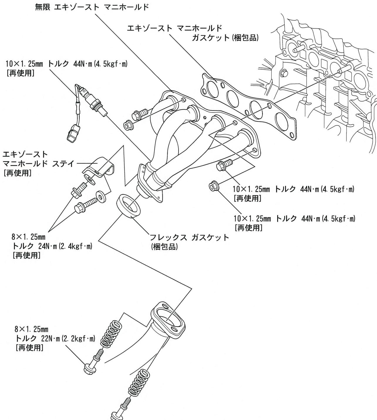
※ エキゾースト マニホールドの取付ボルト/ナットを締付ける際は、内側から外側へ対角に数回に分けて締付ける。
