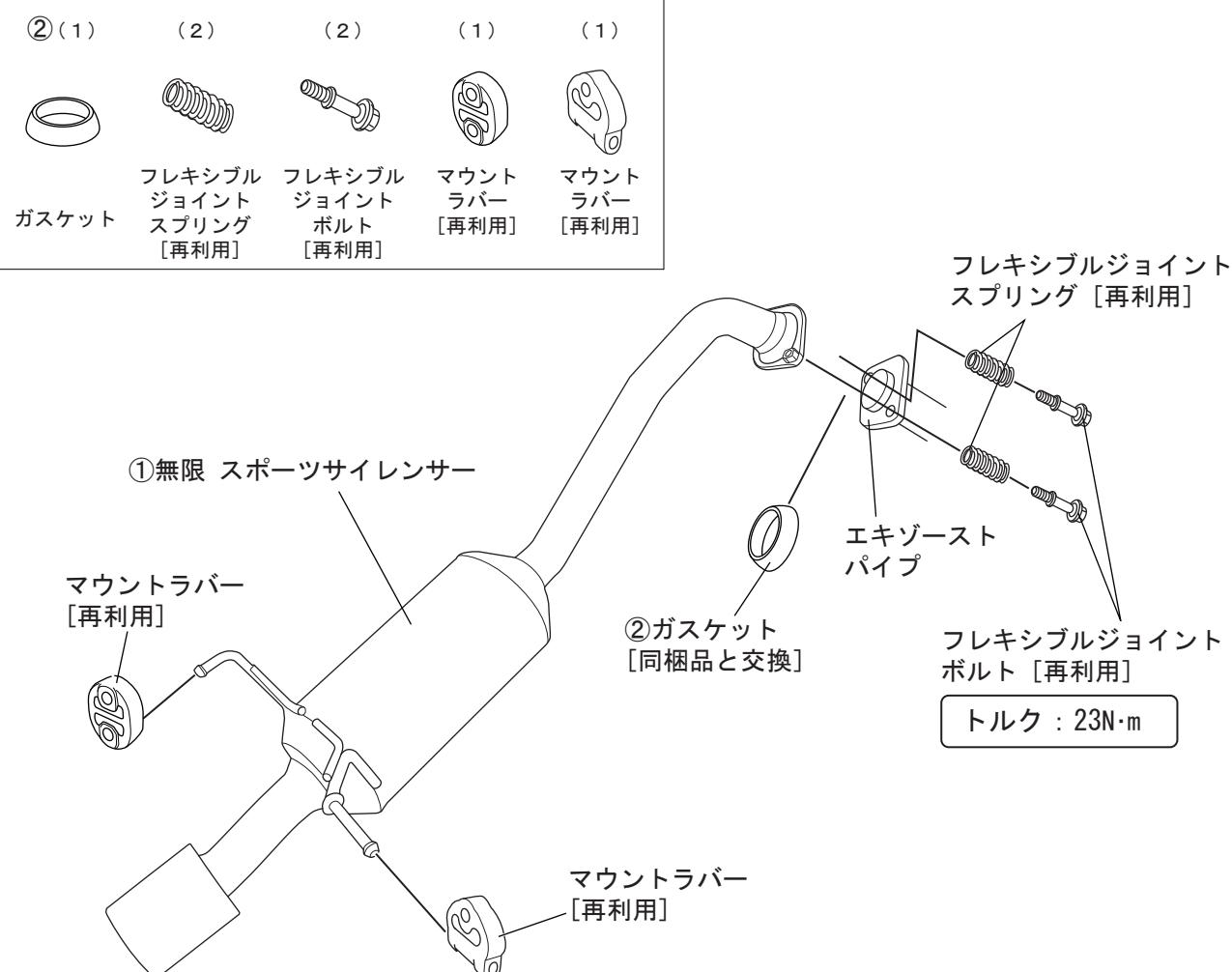
2. リア アンダー スポイラー（リア バンパー）のマフラー アーチ部と①無限 スポーツサイレンサー出口部が均一隙になるように調整する。
