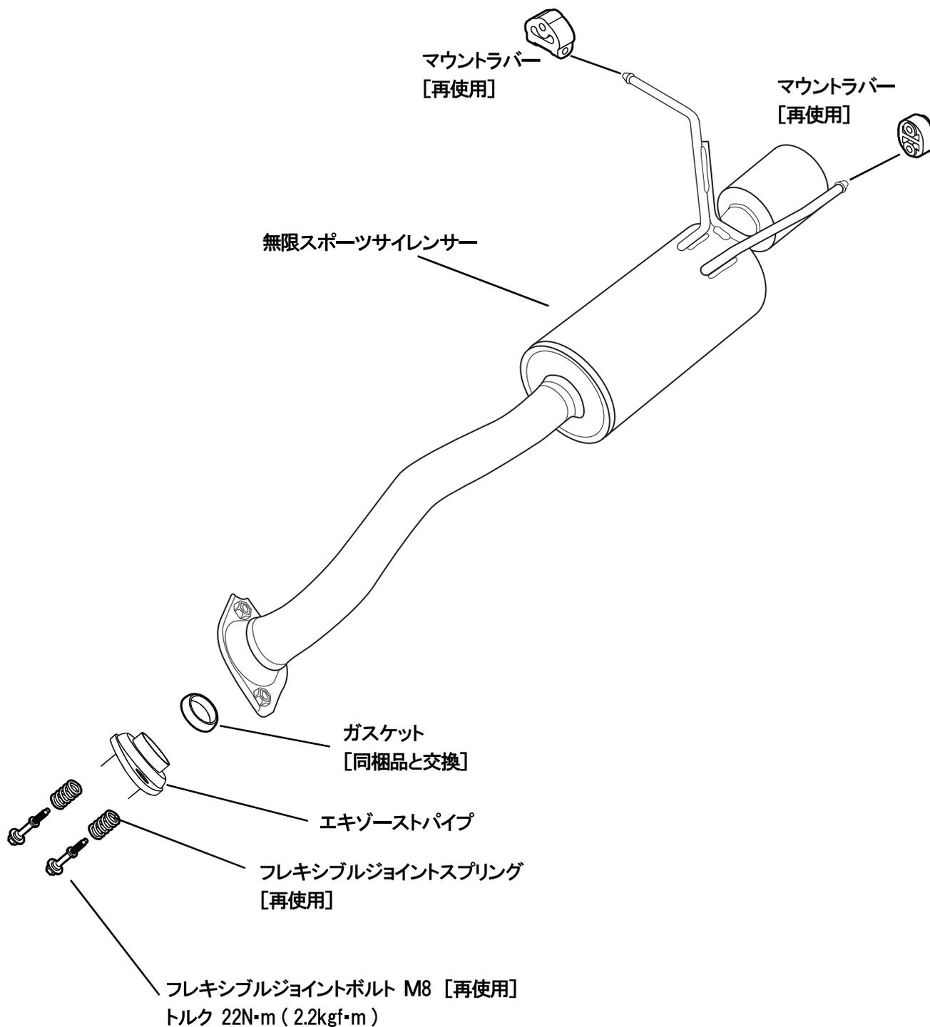
※ボルトを締め付ける際は、両側のボルトを交互に締め付ける。
