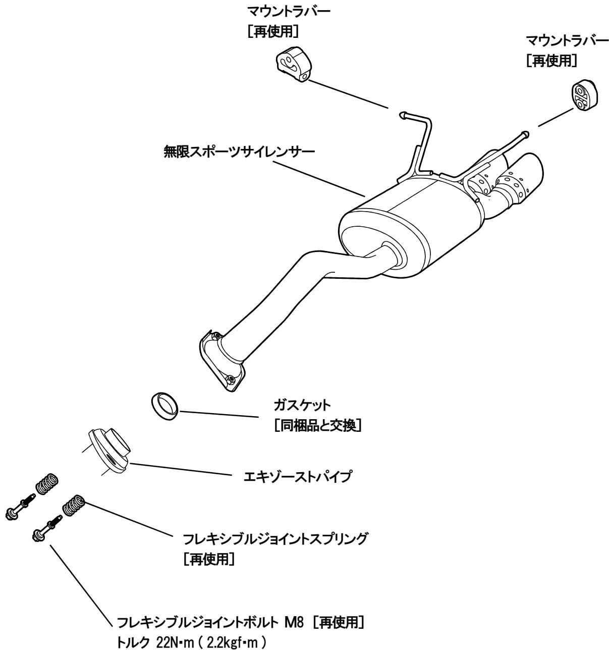
※ボルトを締め付ける際は、両側のボルトを交互に締め付ける。
