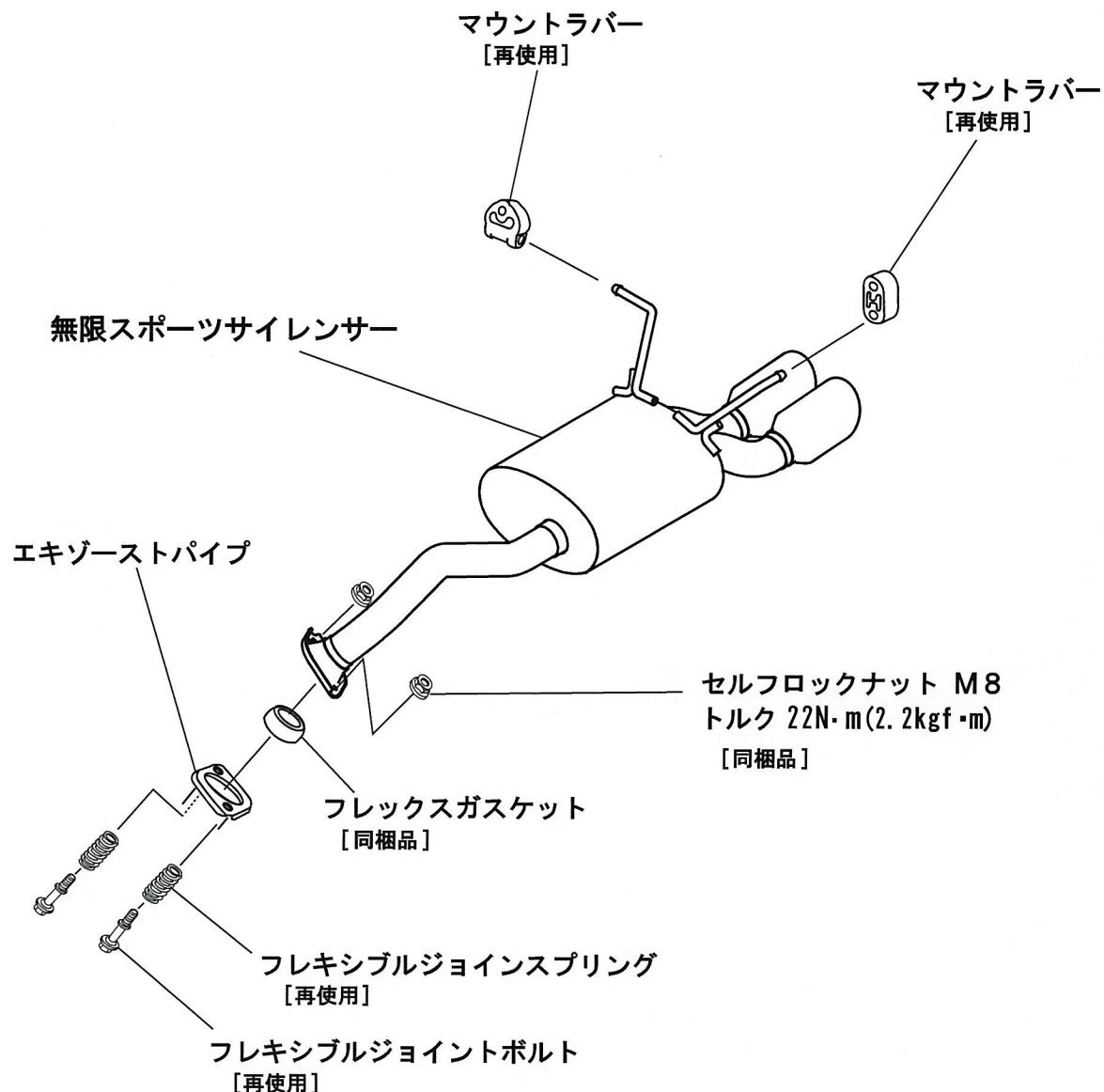
※ 取付ボルトを締付ける際は、両側のボルトを交互に締付ける。
