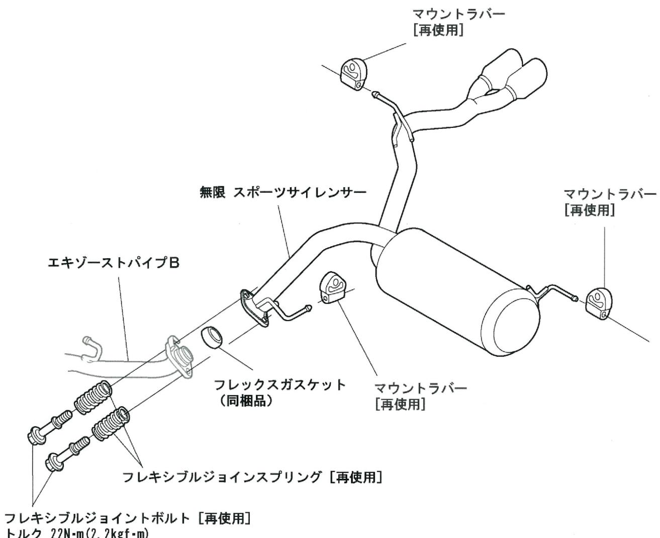
※ 取付ボルトを締付ける際は、両側のボルトを交互に締付ける。
