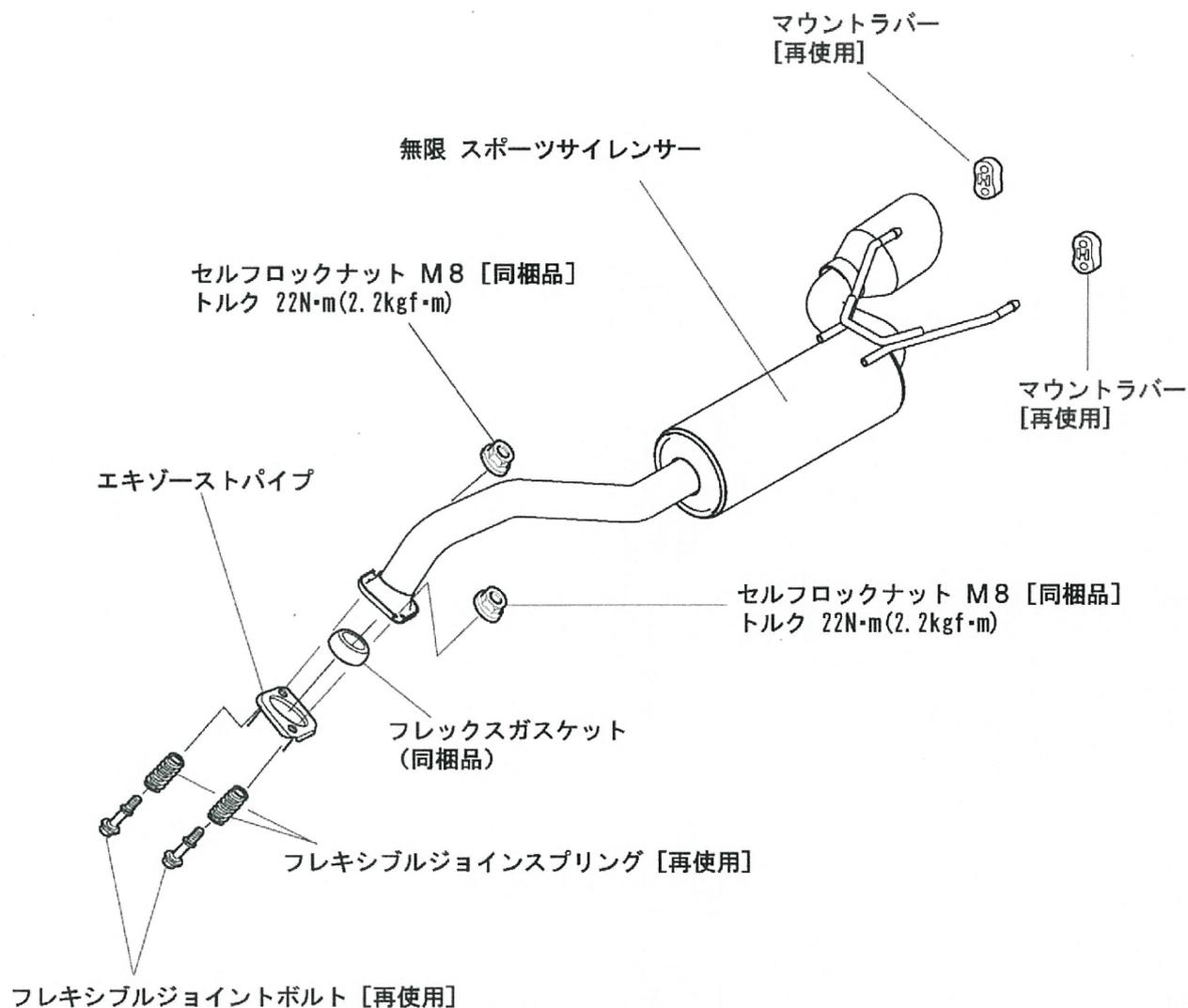
※ 取付ボルトを締付ける際は、両側のボルトを交互に締付ける。
