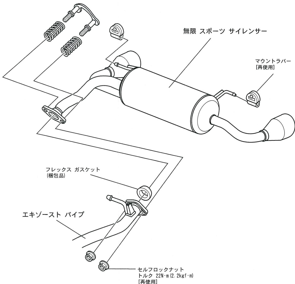
※ 取付ボルトを締付ける際は、両側のボルトを交互に締付ける。
