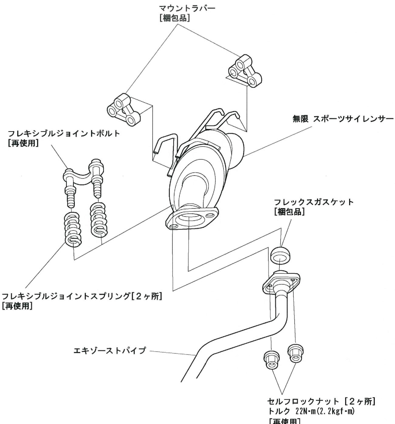
※ 取付ボルトを締付ける際は、両側のボルトを交互に締付ける。
