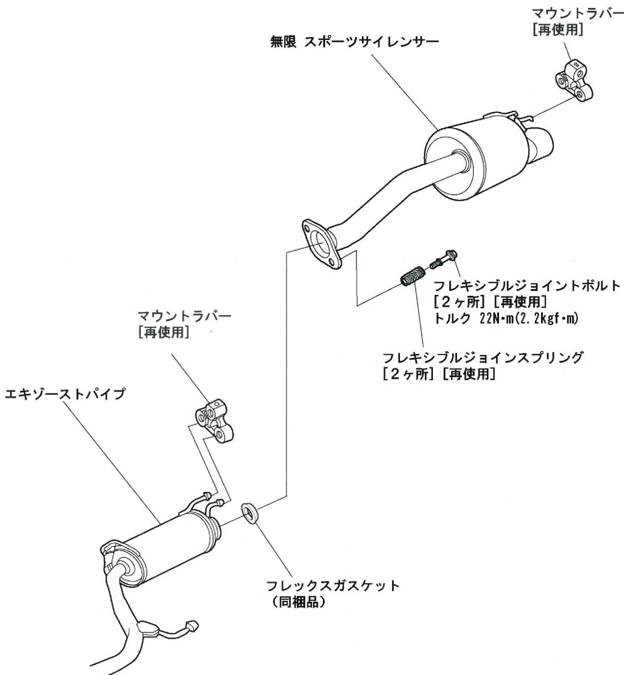
※ 取付ボルトを締付ける際は、両側のボルトを交互に締付ける。
