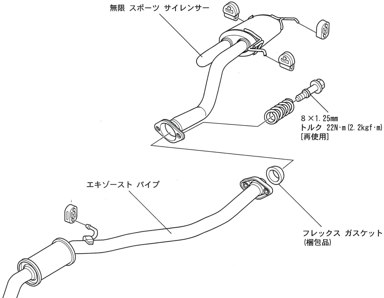
※ 取付ボルトを締付ける際は、両側のボルトを交互に締付ける。
