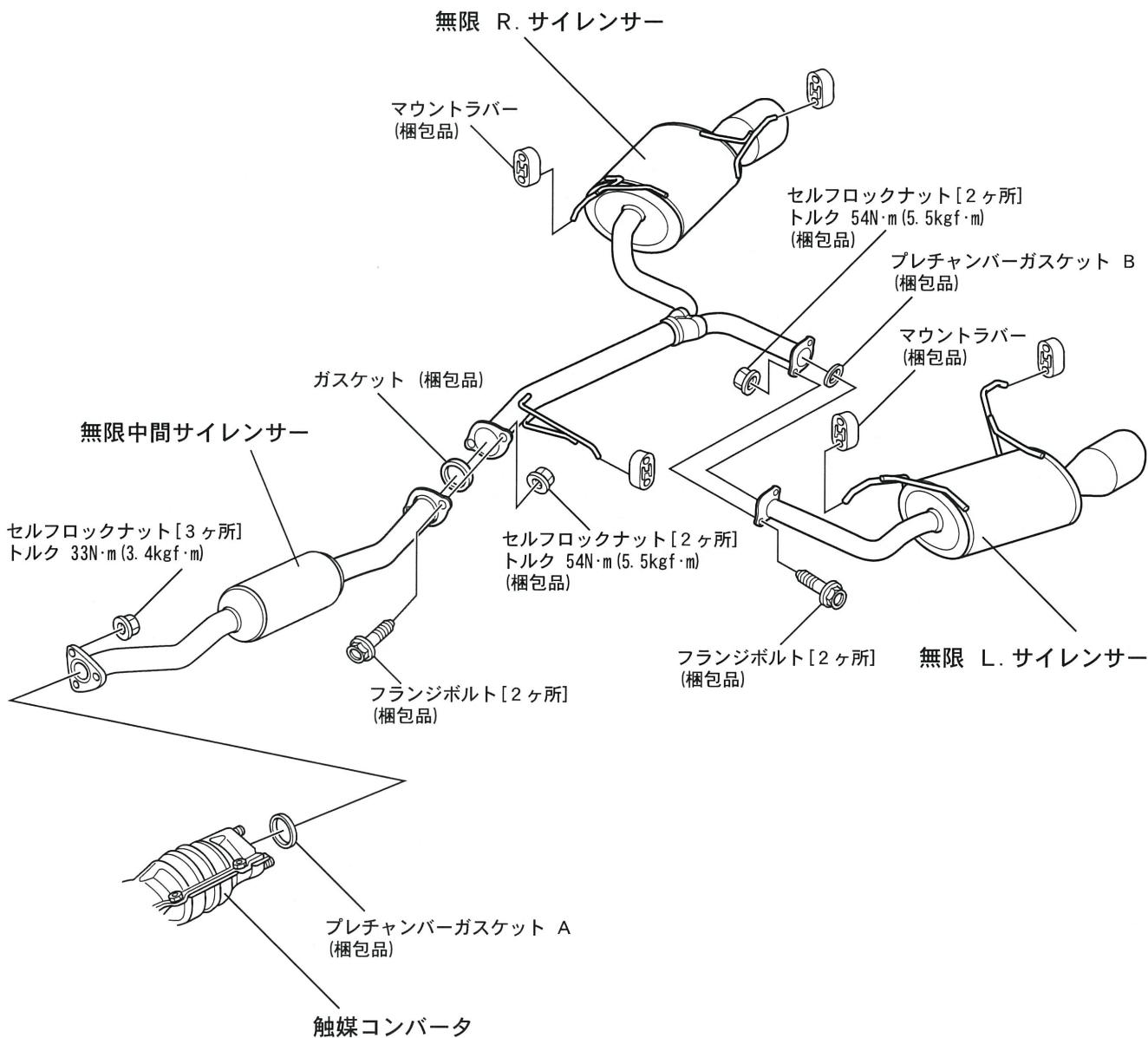
※ 取付ボルトを締付ける際は、両側のボルトを交互に締付ける。
