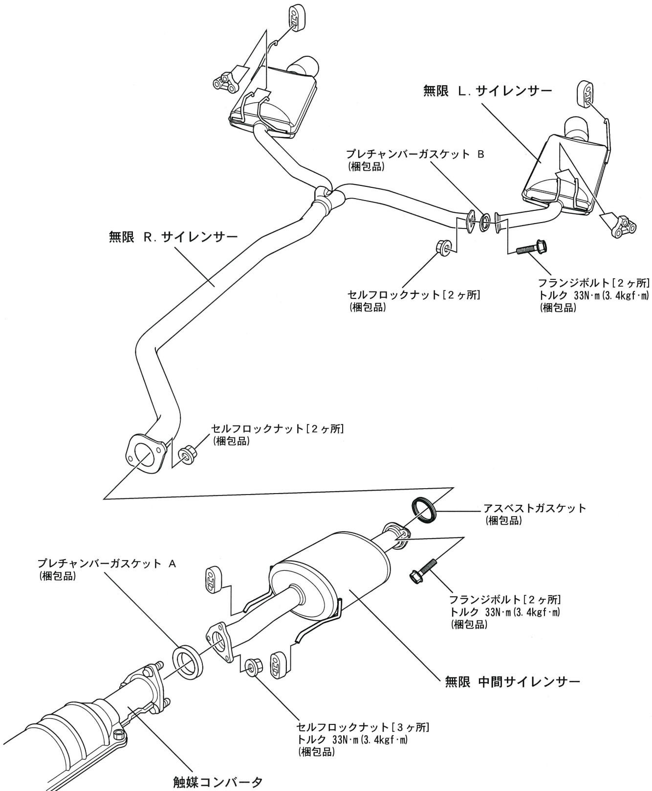
※ 取付ボルトを締付ける際は、両側のボルトを交互に締付ける。
