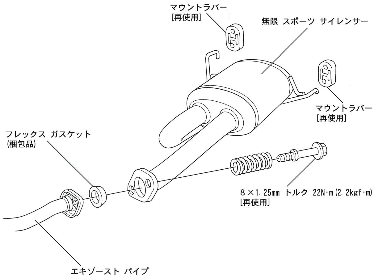
※ 取付ボルトを締付ける際は、両側のボルトを交互に締付ける。
