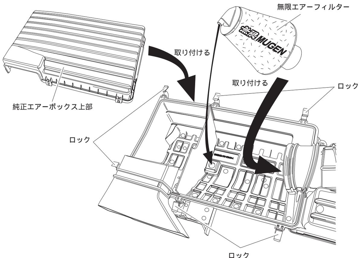
純正エアークボックスカバーを、取り外しと『逆』の手順で、取り付け。
