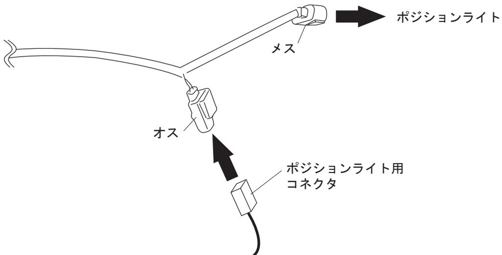
⑨ デイライトハーネスを下図のように配策し、車両アースポイントにデイライトハーネスのアース線(黒)を共締めし、タイラップ及びクッションテープ(3分割して使用)で固定する。
