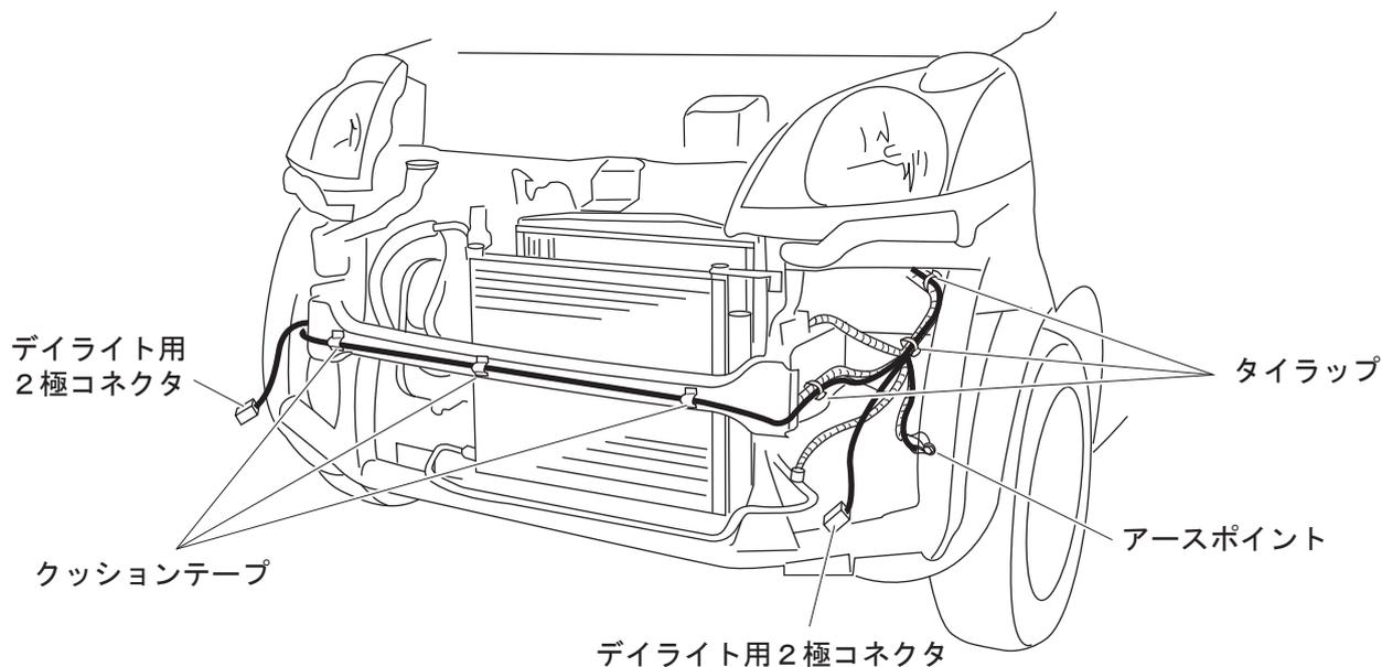
⑩ 車両右側は下図位置にタイラップにて固定する。尚、純正フォグライト装着車はフォグライトハーネスに固定する。
