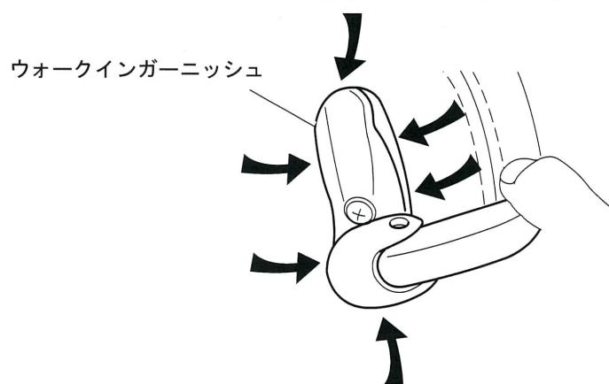
III) タッピングスクリューをドライバーで締め直す。
