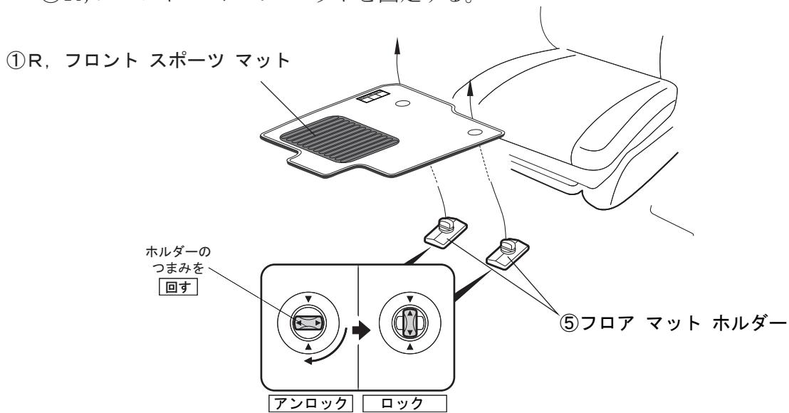
6. ②L, フロント スポーツ マット、③L, リア スポーツ マット、④R, リア スポーツ マットを車両のフロア形状に沿わせて敷く。
