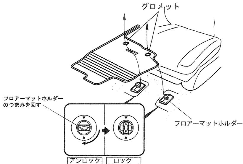
⑧残りのフロアーマットを「構成部品表」のレイアウトで取り付ける。
