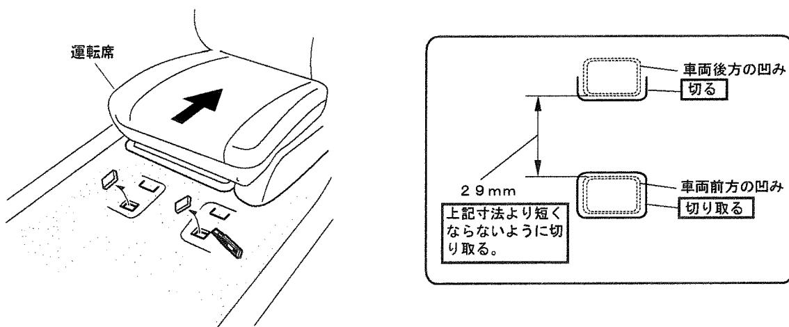
③フロアーカーペットとインシュレーターの間にフロアーマットホルダーを差し込むすき間を作るようにフロアーカーペットを持上げる。
