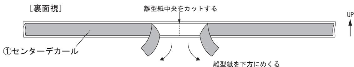
3. ①センター デカールのアプリケーション フィルムをリア バンパーの上方に突き当て、左右均一隙を確認しながら取り付け位置がずれないように離型紙を矢印の方向に引き抜き圧着する。
