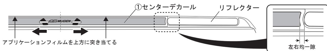
4. ②サイド デカール裏面の両面テープの離型紙を全て剥がし、アプリケーション フィルムをリア バンパー形状に合わせて突き当て、取り付け位置を確認しながら圧着する。
