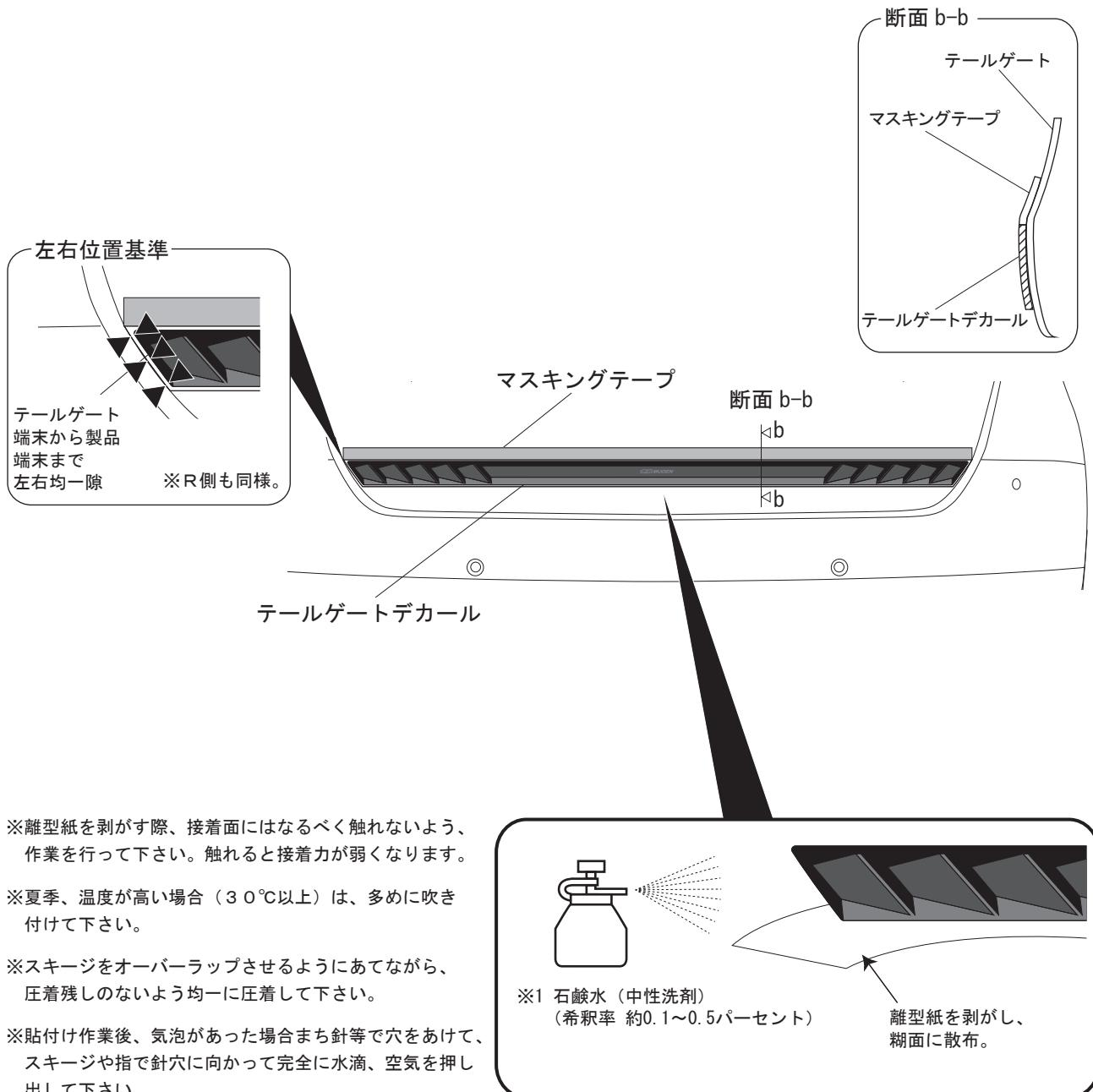
※離型紙を剥がす際、接着面にはなるべく触れないよう、作業を行って下さい。触ると接着力が弱くなります。
