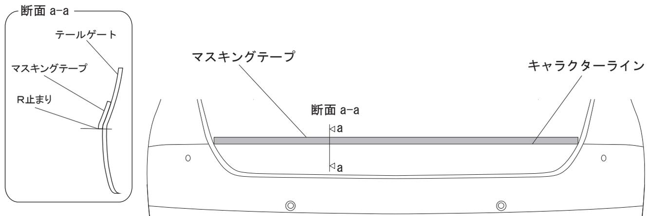
③離型紙を剥がし、テールゲート及びデカールの糊面に霧吹きで石鹼水※1 をかけ、左右方向は左右位置基準、上下方向はデカール上端をマスキングテープ下端に合わせて貼付ける。
