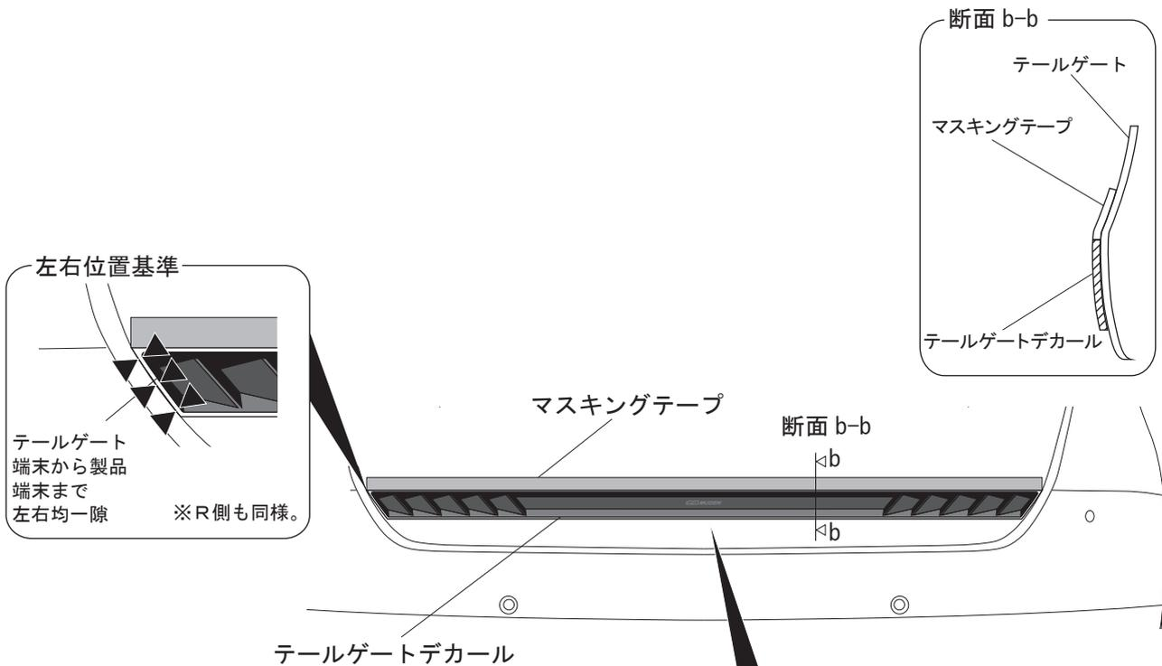
※離型紙を剥がす際、接着面にはなるべく触れないよう、作業を行って下さい。触れると接着力が弱くなります。
