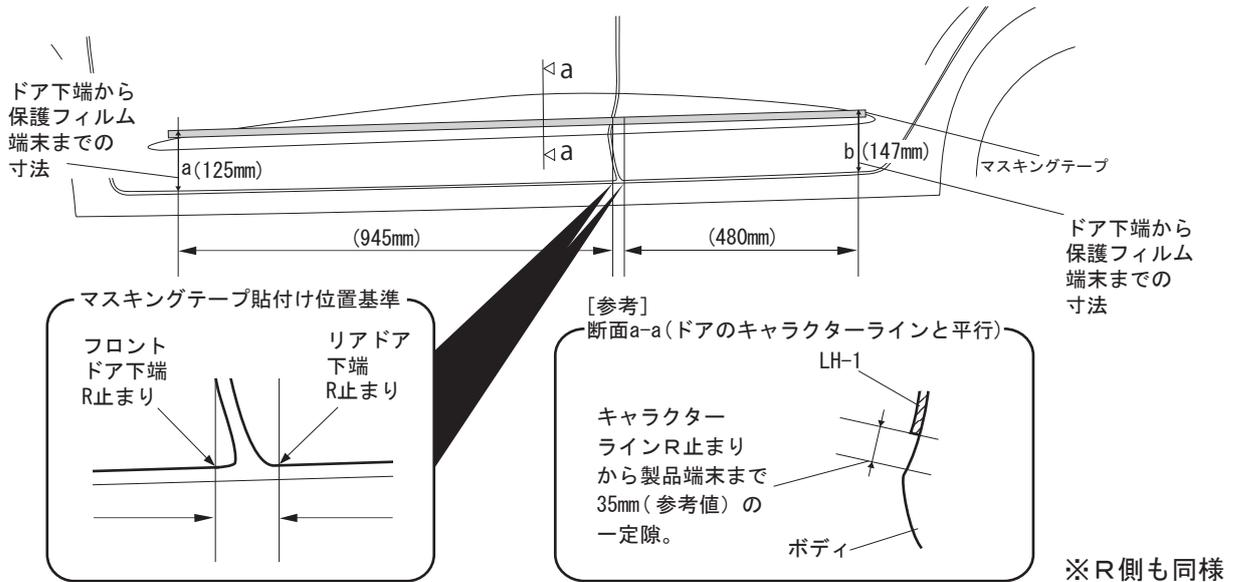
③ LH-1 の離型紙を剥がし、フロントドア及びデカールの糊面に霧吹きで石鹼水をかけて位置基準Aとマスキングテープに合わせて貼付けます。
