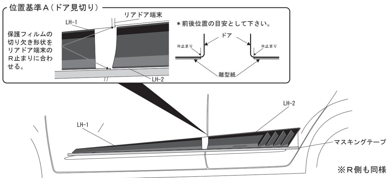
⑥貼付けが完了後(水が抜けたら)約20分置いて保護フィルムとマスキングテープを剥がしてLH-2の貼付けは完了です。
