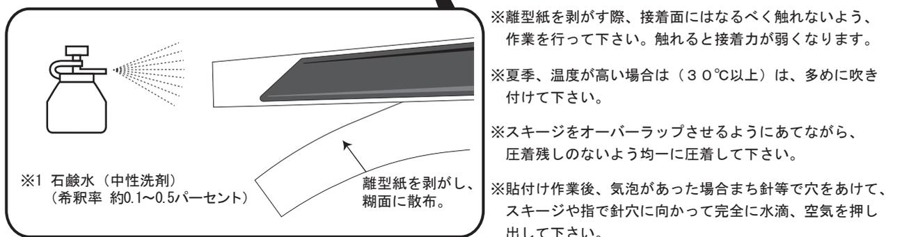
④貼付けが完了後(水が抜けたら)約20分置いて保護フィルムを剥がしてLH-1の貼付けは完了です。
