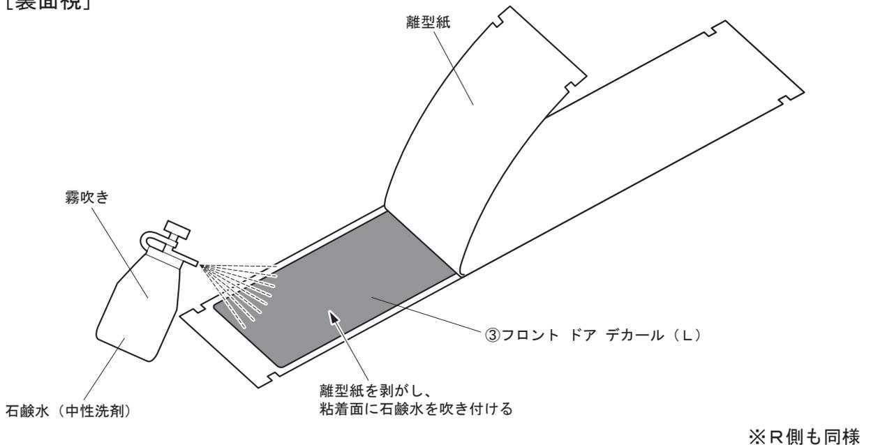
4. 石鹼水（中性洗剤）をフロント ドアに吹き付け、③④フロント ドア デカール（L/R）をフロント ドアに合わせる。
