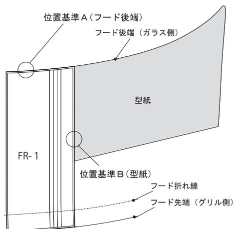
⑧リヤドアの貼付け面をイソプロピルアルコールで脱脂をし、RR-1を型紙と位置基準AとBを合わせて②、③の要領で貼り付ける。
