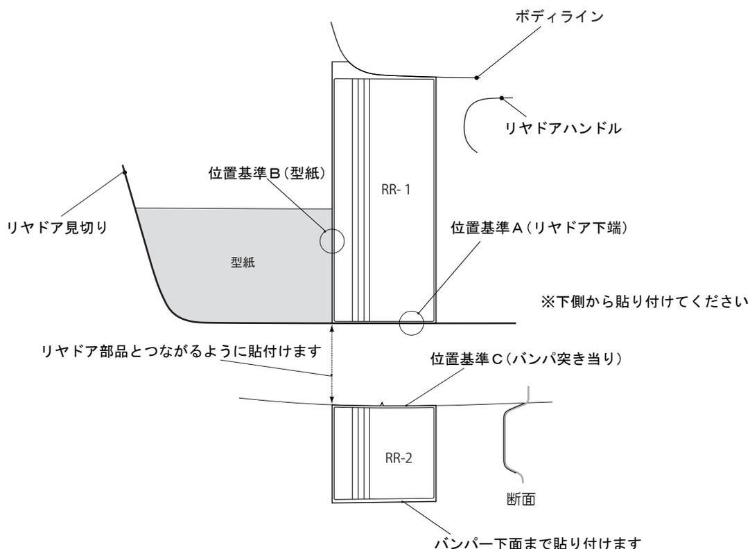
⑩取付け状態が完全か確認をし、貼付け後24時間は、雨、水などで濡れないよう注意してください。
