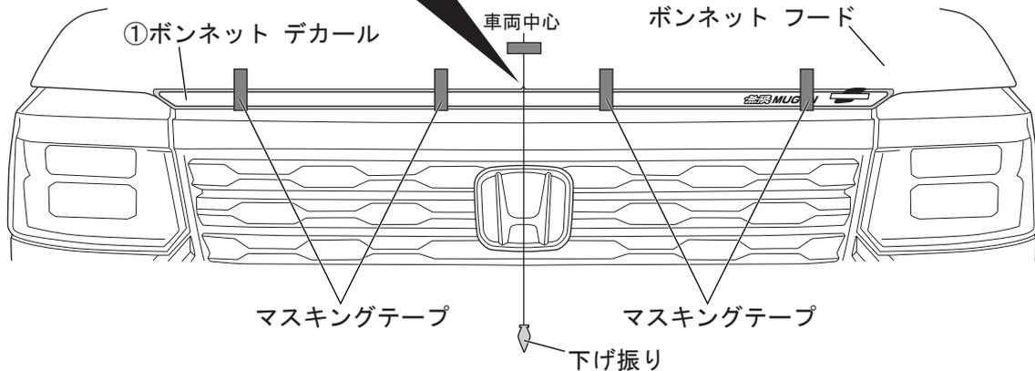
5. 取付位置を確認して離型紙を矢印の方向に引き抜く様に剥がし圧着する。圧着の際、気泡が入らないよう注意すること。
